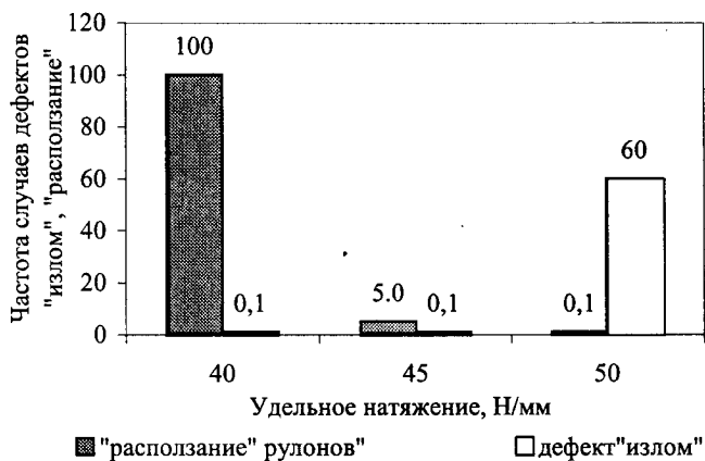
Рис. 2. Качество полос, смотанных при различных натяжениях на моталке 2-х клетового стана
