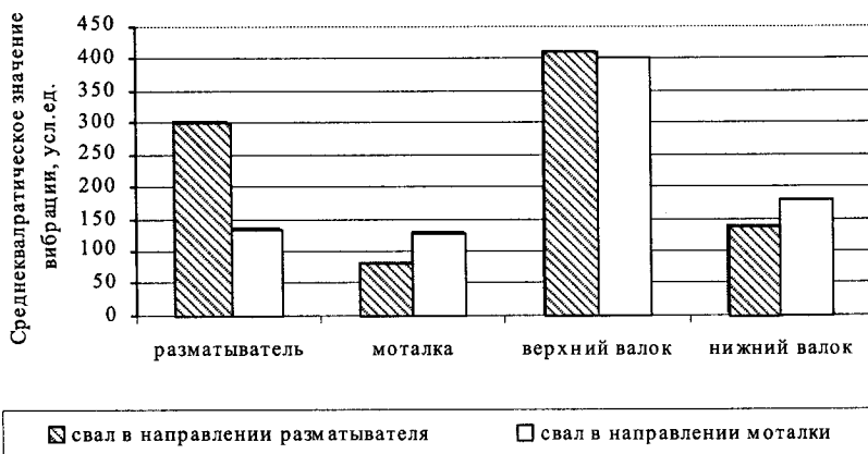
Рис. 4. Вибрация механического оборудования дрессировочного стана 2500 при различном направлении свала рабочих валков во время дрессировки со скоростью 15 м/с
