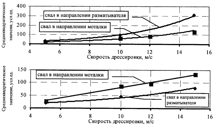
Рис. 3. Зависимости среднеквадратических значений вибраций от скорости дрессировки при различном направлении свала рабочих валков относительно опорных: а) размотки; б) моталки
