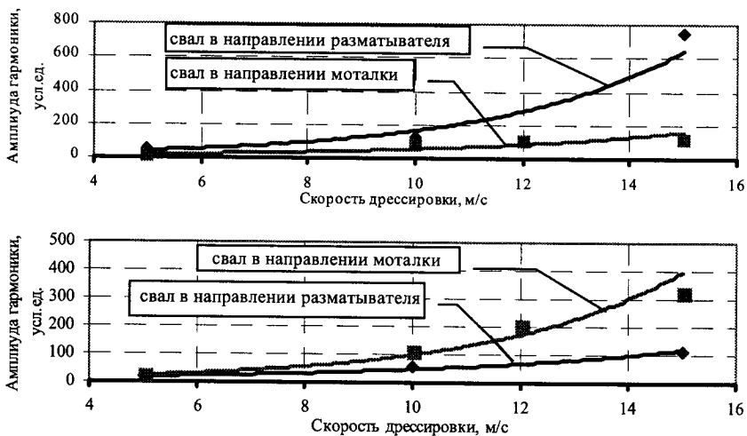
Рис. 2. Зависимости амплитуд гармоник вибраций от скорости дрессировки при различном направлении свала рабочих валков относительно опорных: а) размотки в диапазоне частот 1000÷1400 Гц; б) моталки в диапазоне частот 400÷600 Гц
